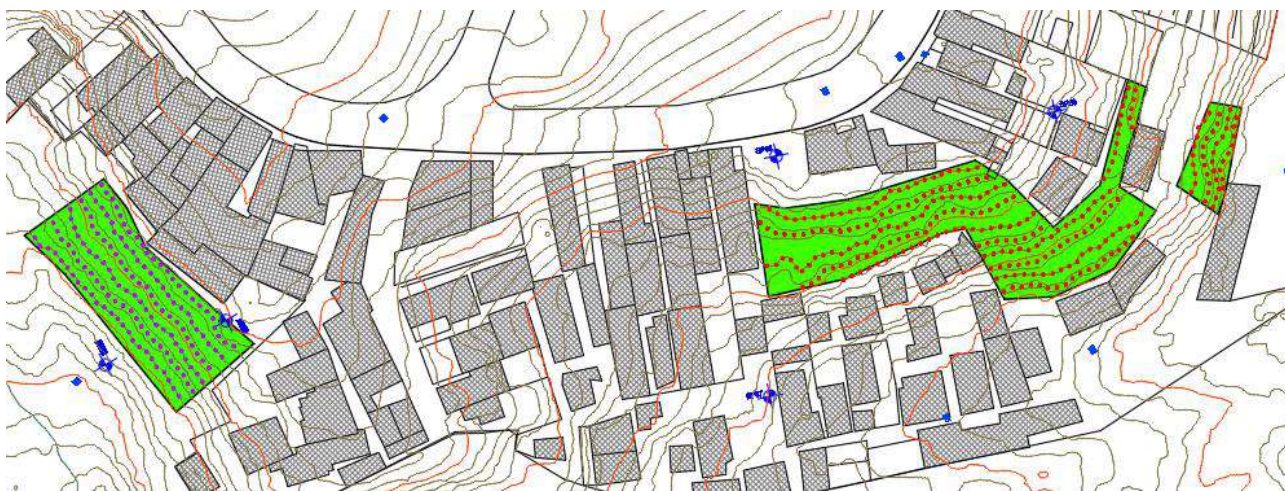
Figura 3 – Imagem em Planta da solução adotada – Região da Rua Seridó Junior, com grampos em roxo de 6,0 m e em vermelho de 12,0 m.
