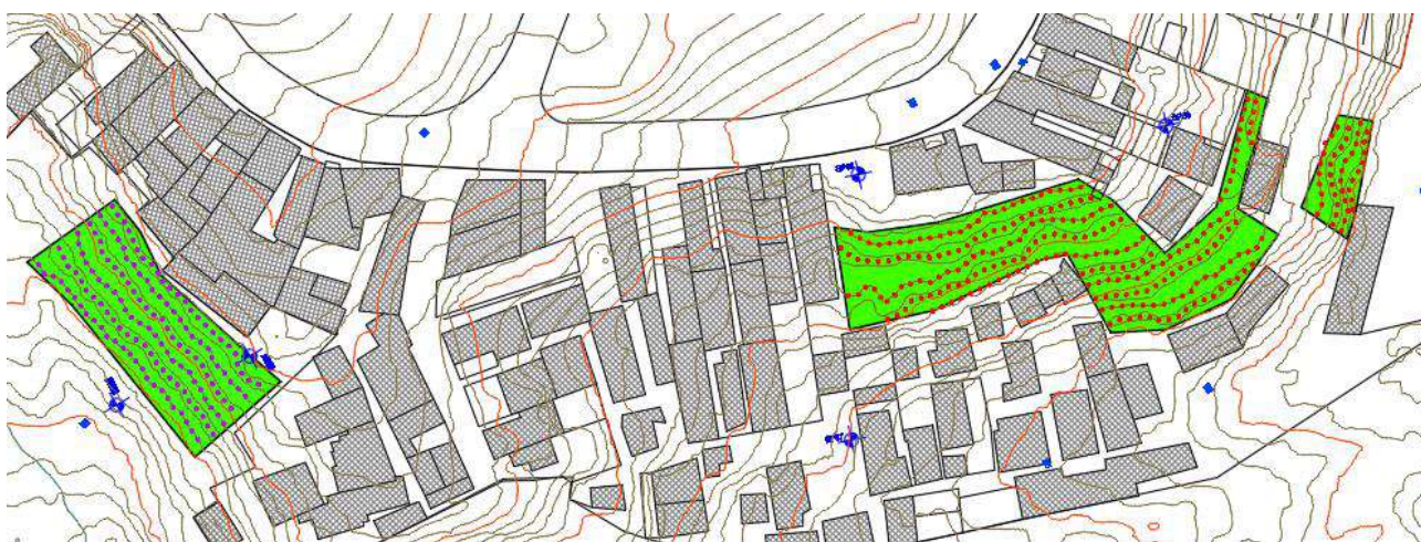
Figura 5 – Imagem em Planta da solução adotada – Região da Rua Seridó Junior, com grampos em roxo de 6,0 m e em vermelho de 12,0 m.
